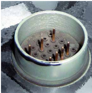
01 Die verschmutzten Kontakte bei diesem Profibus Desina Steckverbinder führten zum Prellen der Steuerspannung beim Zuschalten eines Slaves
