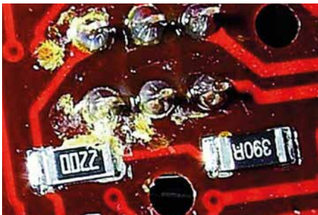
03 Nicht vollständig entfernte Flussmittelreste werden zusammen mit Feuchtigkeit leitfähig
