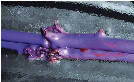
02 Chemische Einflüsse beschädigten die Isolierung dieser Profibus DP-Leitung
