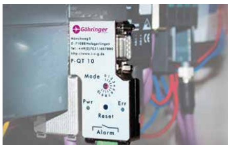
04 Der Profibus-Quick Tester P-QT 10 ist ein kompaktes Diagnose-Modul für die Langzeitüberwachung von Profibus-Systemen
