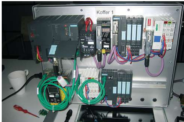
Bild 2: Diagnose- und Schulungskoffer für Profibus-Applikationen.
