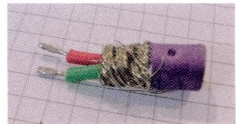
Das Lot fließt unter dem mechanischen Druck der Schraubklemme, so dass sich die Verbindung im Laufe der Zeit lockert.
