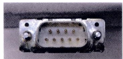
Deutlich sichtbare Verfärbungen am Steckverbinder, entstanden durch einen zu hohen Schirmstrom.
