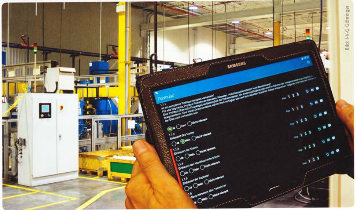
Bild: Schwachstellenanalyse anhand einer Tablet-gestützten Sichtprüfung.
