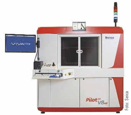
Das Pilot 4D V8 HF verbindet Flying Probe mit Hochfrequenz-Messung.
